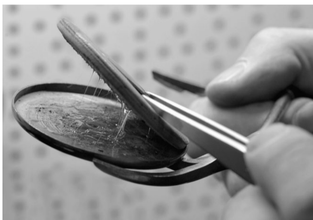
Mit einer Pinzette entfernt Blasinstrumentenmachermeister Menken ein Polster von der Klappe.
