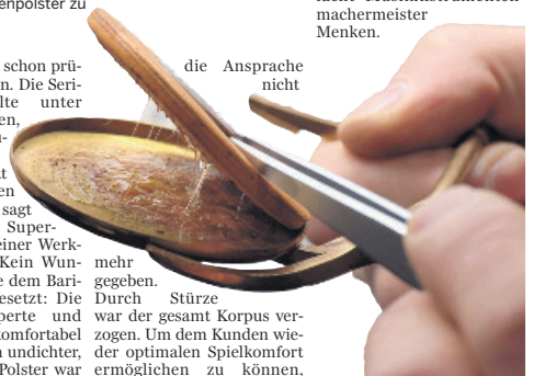
Rund 40 Stunden Handarbeit hat Hilko Menken investiert, um das Selmer-Saxofon wieder fit zu machen. Seine Devise: „Es ist besser, den Dingen Zeit zu geben, gerade im Handwerk“. Die Arbeitsstunden hat er unter anderem benötigt, um mit der Pinzette die Klappenpolster zu entfernen (rechts unten) und sie zu erneuern.
